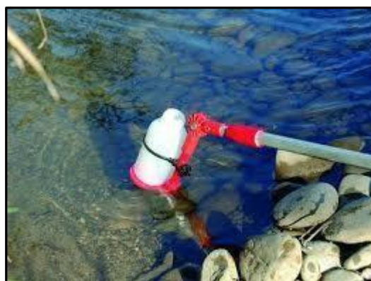
Figura | Esempio di campionatore telescopico per acque superficiali
