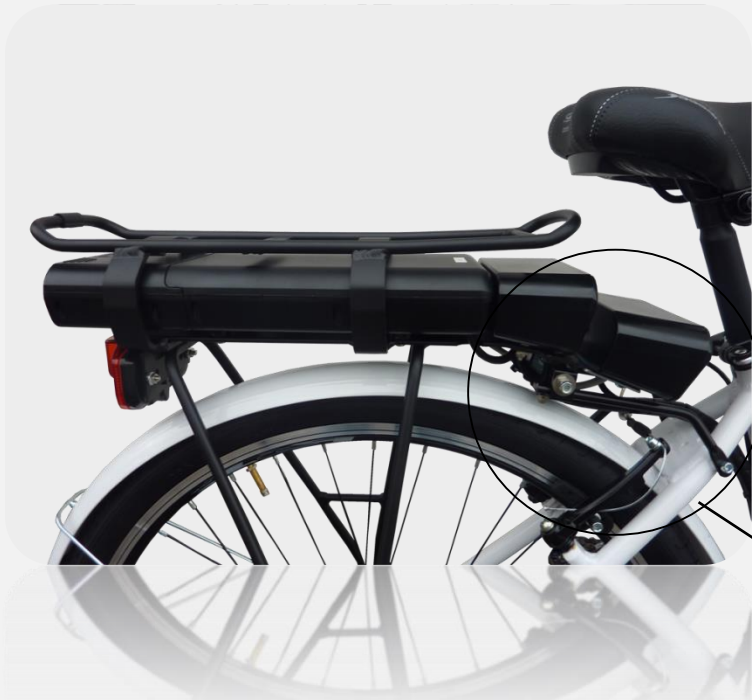
Particolare scatola centralina e scatola alloggiamento tracker GPS
