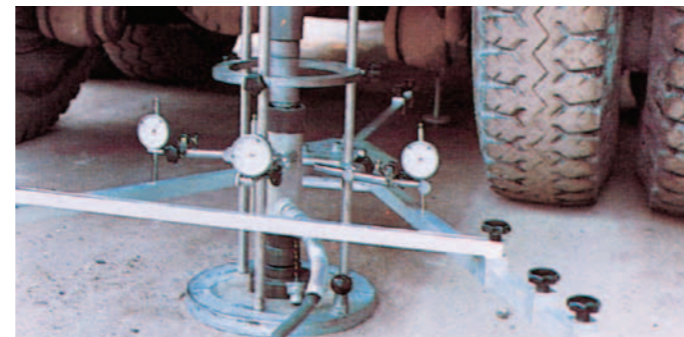
Foto 1/2/3 - Autostrada Milano-Sesto Calende: fresatura del terreno additivato con cemento GLORIT ® ; prova di piastra sul terreno trattato; a lavoro ultimato.
