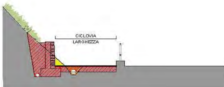
I3 - REALIZZAZIONE CICLOVIA IN SEDE PROPRIA CON OPERE D'ARTE (MURO DI SOSTEGNO)
