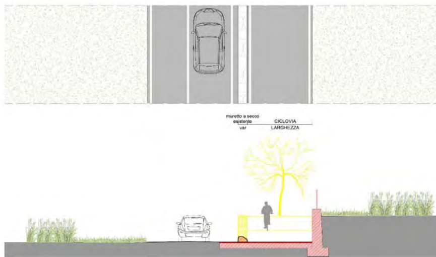
G20 - NUOVA CICLOVIA IN SEDE PROPRIA CON CORDOLO MURATURA IN PIETRA E ABBATTIMENTO PIANTE
