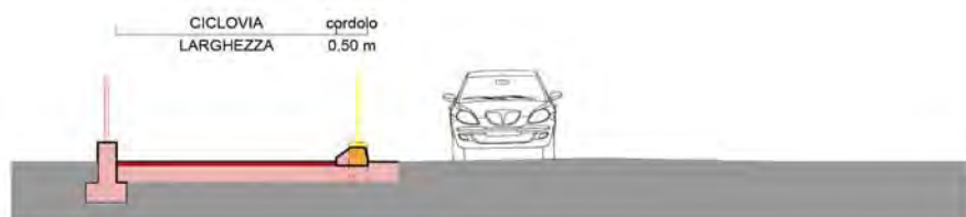
G11 - NUOVA CICLOVIA IN SEDE PROPRIA IN ALLARGAMENTO STRADA E ARRETRAMENTO RECINZIONI
