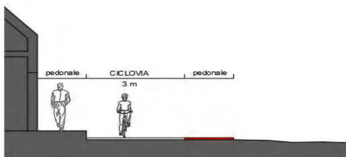
O24 - ALLARGAMENTO DI PERCORSO PEDONALE ESISTENTE
