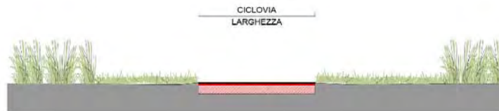
G15 - NUOVA CICLOVIA A PIANO CAMPAGNA CON PAVIMENTAZIONE SLURRY
