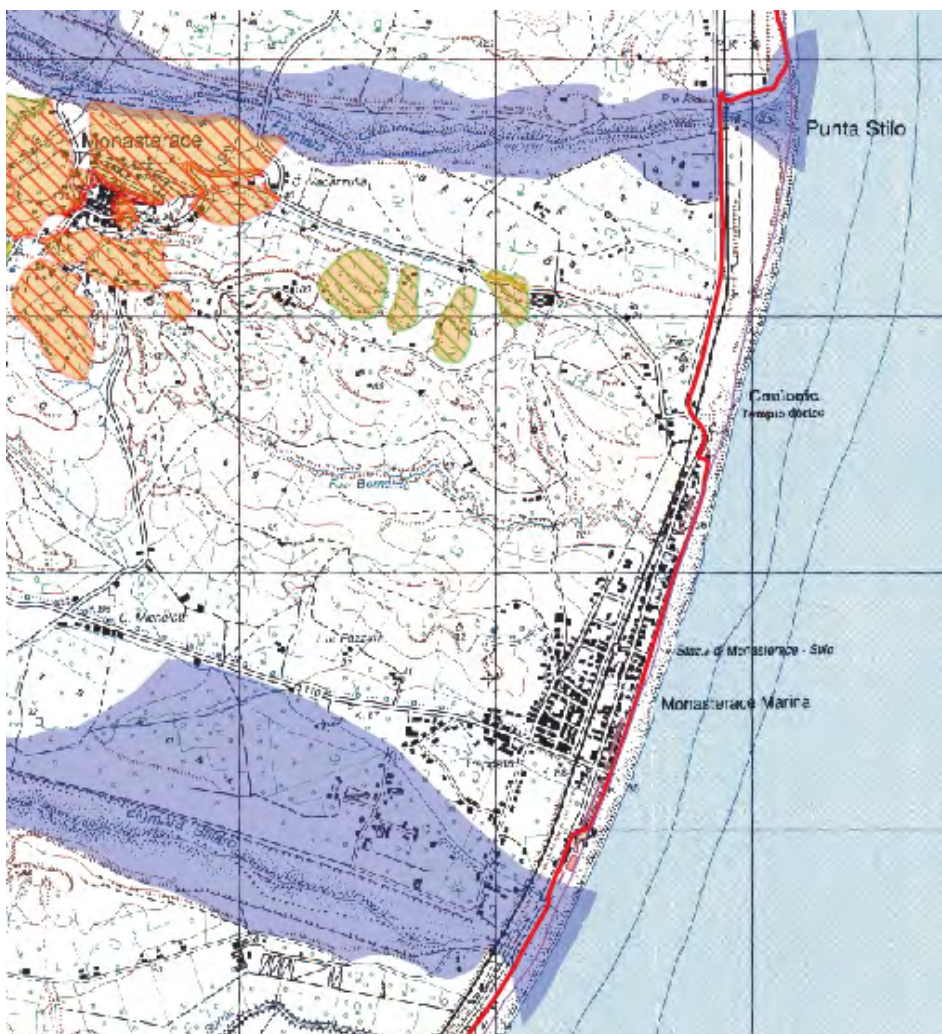
Fig. 47 - Stralcio dei dissesti del PAI classificati per livelli di rischio (R1 – R4) e della pericolosità idraulica nell'area CA10.
