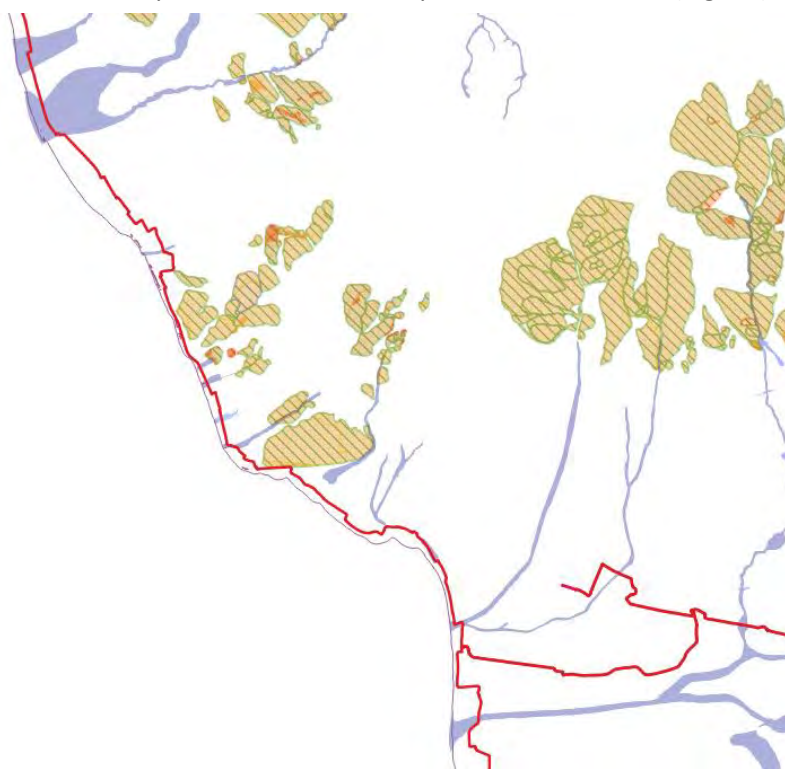
Fig. 39 - Stralcio dei dissesti del PAI classificati per livelli di rischio (R1 – R4) e della pericolosità idraulica nell'area CA03_4.
