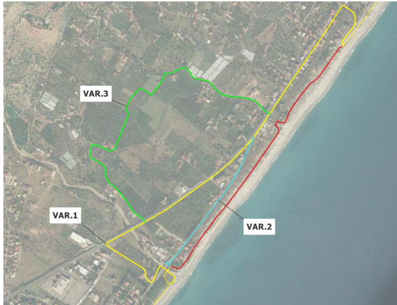
Il tracciato di progetto prevede il passaggio sul litorale su fondo sabbioso, sviluppandosi in un'area compresa tra la linea costiera e la ferrovia. Al fine di individuare il tracciato che più rispecchia le volontà e le esigenze progettuali sono stati analizzati 3 percorsi alternativi, descritti di seguito.
