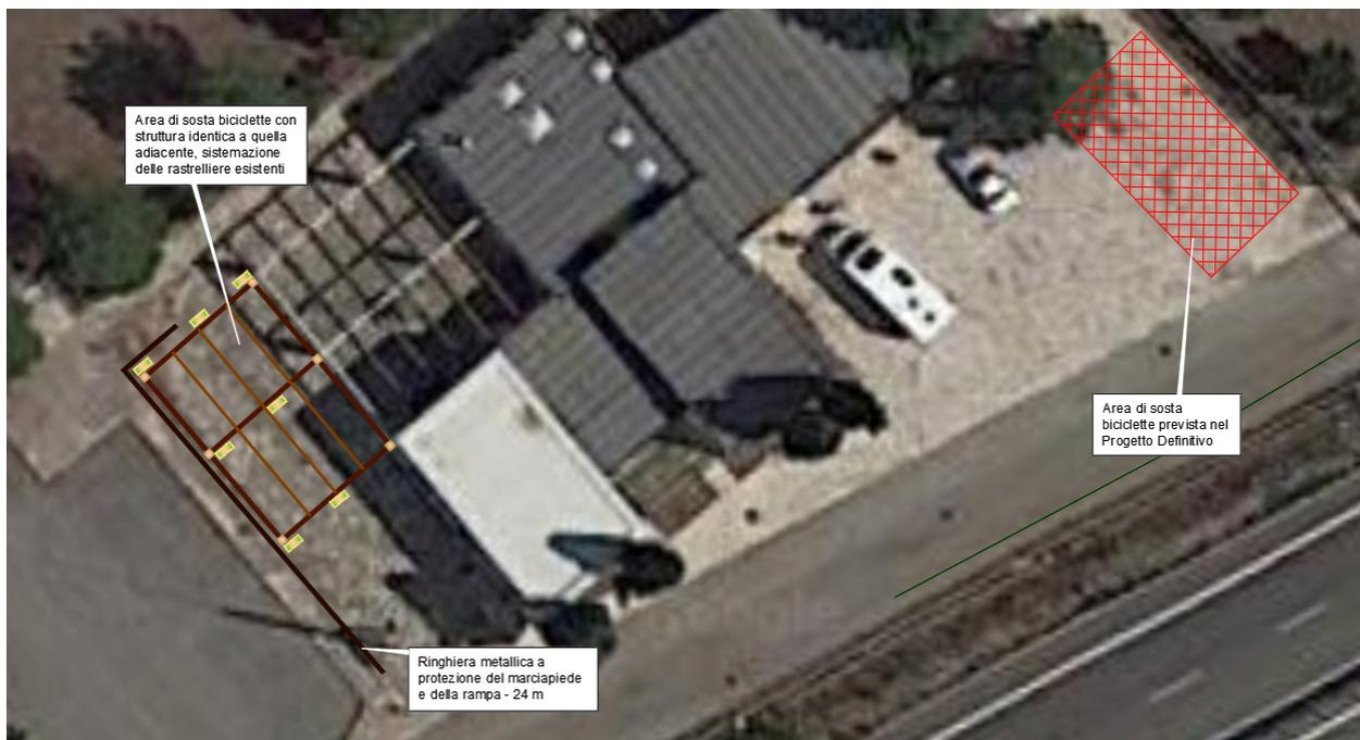
Figura 3 – Planimetria con posizionamento della nuova area di sosta e della nuova ringhiera in acciaio Corten
