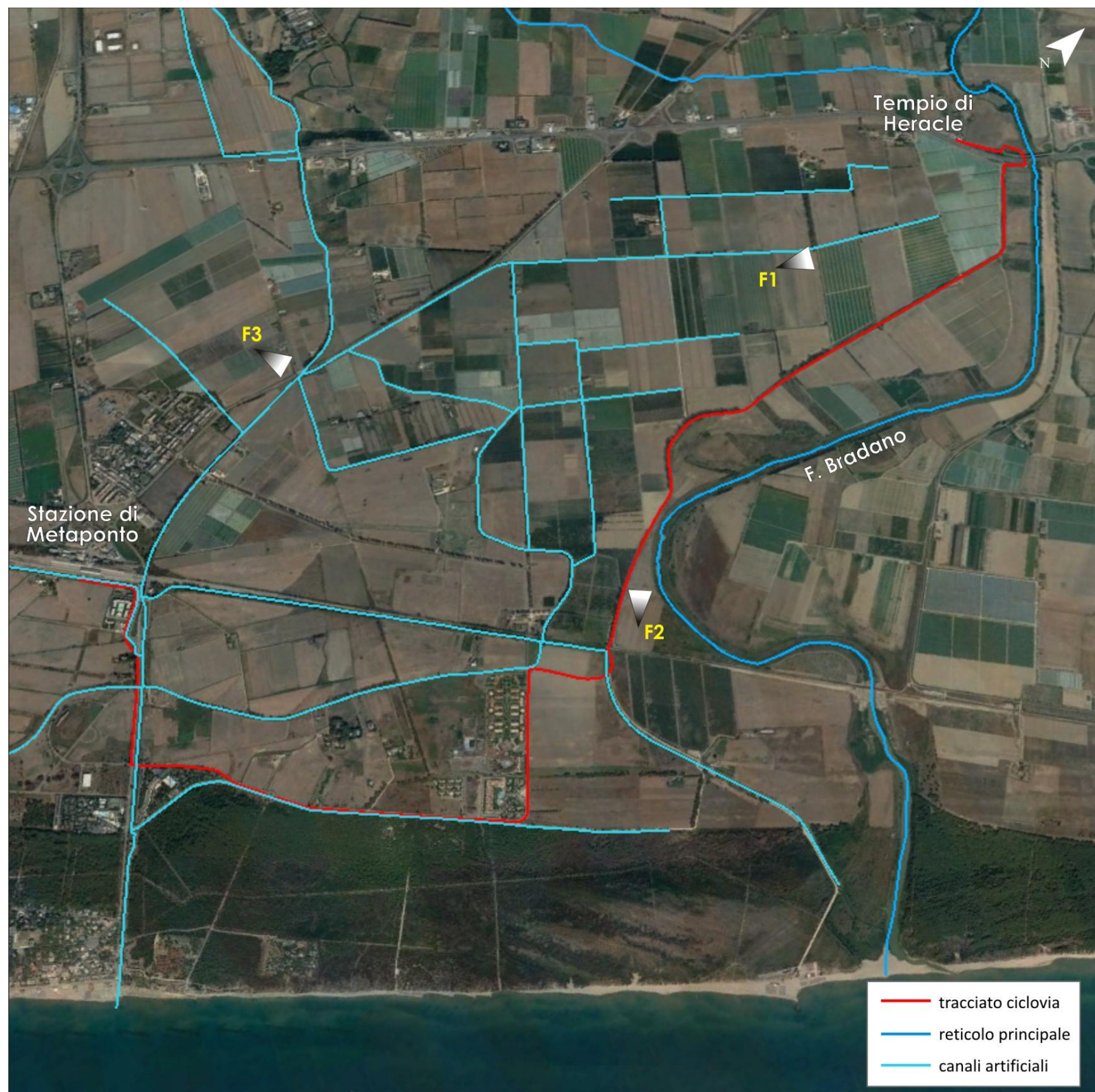
Figura 10 - Reticolo idrografico dell'area di intervento. Gli alvei dei corsi d'acqua risultano generalmente poco incisi (Foto 1) e soltanto a tratti sono riconoscibili degli argini ben definiti morfologicamente (Foto 2). Inoltre la scarsa manutenzione dei canali artificiali ha favorito la crescita della vegetazione che contribuisce a ridurre la funzionalità idraulica della rete di drenaggio (Foto 3).
