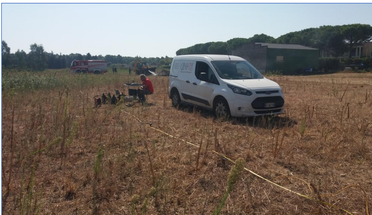
Foto 1 e 2 - Acquisizione dati sismici.
