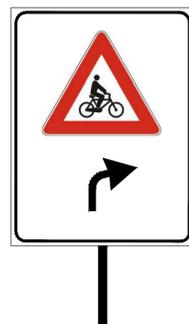
Pannello con segnale di PERICOLO ATTRAVERSAMENTO CICLABILE dopo svolta a destra (o a sinistra) Fig. II.14 Art.88 (dimensioni 60x90 cm)
