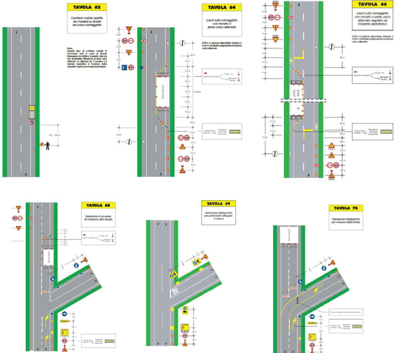
Figura 9: Esempi di schemi segnaletica di cantiere da adottarsi in corrispondenza delle SS e SP
