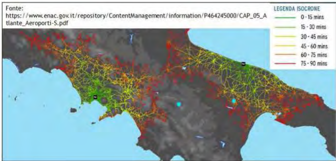
Figura 130 Isocrone di accessibilità su rete stradale degli aeroporti di Napoli e Bari
