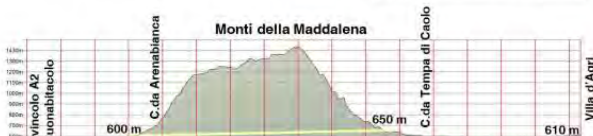
Figura 425 Dorsale trasversale di collegamento Costa Jonica - Matera – Val d'Agri – Golfo di Policastro: caratteristiche costruttive e profilo stradale
