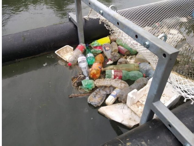
Figura 44. Barriere galleggianti per l'intercettazione dei rifiuti flottanti.
